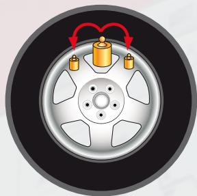
**Parfaite esthétique de la jante** parce qu'elle permet de diviser la masse d'équilibrage adhésive du flanc extérieur en deux masses équivalentes placées dans une position cachée derrière les branches.
